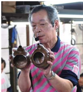
玉川堂は1816年創業。1枚の銅板を叩いて継ぎ目のない急須などを作る高い技術で知られる
