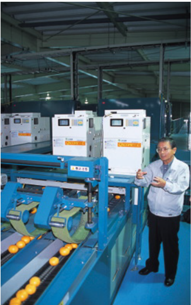
「光センサーによる非破壊糖酸度分析装置は一つ一つ機械の目でチェックされます」と語る清水さん
