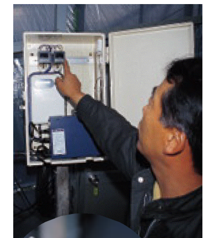
ハウス内の温度を携帯電話にメールするビニールハウスの監視装置
